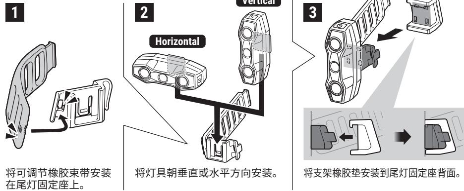
将可调节橡胶束带安装在尾灯固定座上。
